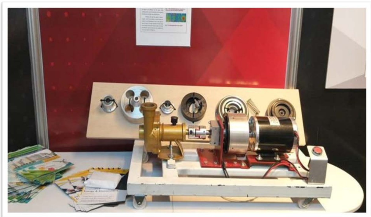
ภาพอุปกรณ์ส่งกำลังระบบปั๊มสูบน้ำพลังงานแสงอาทิตย์
